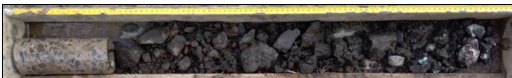
Obr. č. 5 – diagnostický vrt V3
