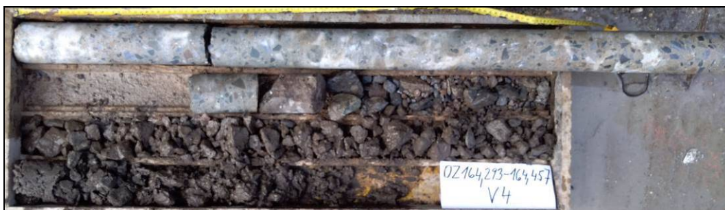
Obr. č. 6 – diagnostický vrt V4
