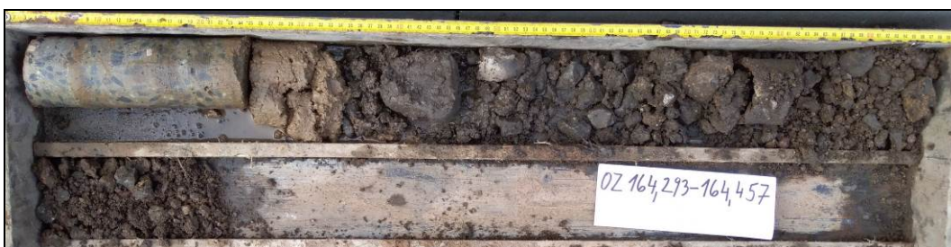
Obr. č. 3 – diagnostický vrt V1
